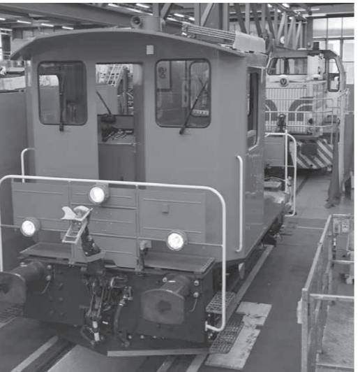
Umbau von einem Fahrzeug sind die oft fehlenden Detailpläne und die Ungewissheit über mögliche nicht sichtbare Materialermüdungen z.B. im Bereich des Drehgestelles, Wagenkastens, etc. Dies bedeutet, dass viele Vorabklärungen nötig sind, was kostenintensiv ist.
